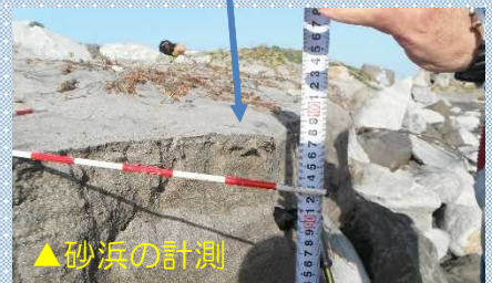
▲砂浜の浸食（浜がけ）
