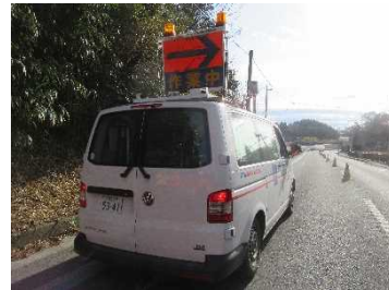
舗装点検調査： 舗装の傷みを点検・調査し、特に傷んでいる箇所は、新しく敷きなおす
