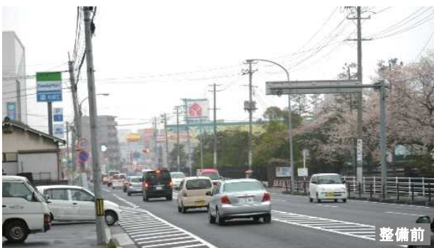
倒壊等により交通の妨げとなる電線や電柱を撤去し、被災時でも交通の確保が可能となるよう電線共同溝を整備（国道45号 仙台市宮城野区）
