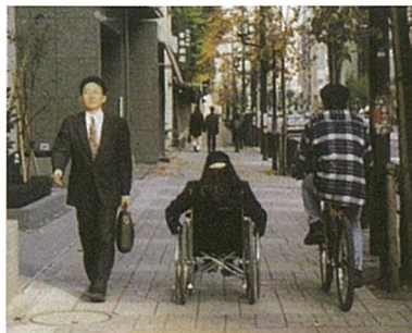
電柱が無くバリアフリー化された歩道
