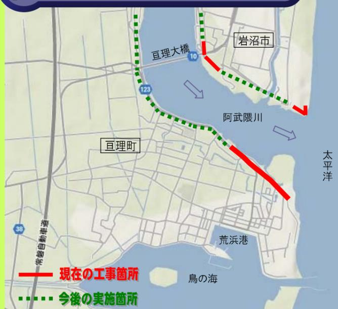
岩沼出張所では、阿武隈川河口から約2.2kmの堤防を対象に、平成27年度完成を目標とし津波や地震に強い堤防の本復旧工事を行っています。
