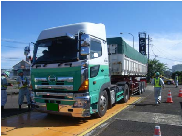
特殊車両の重量測定状況
