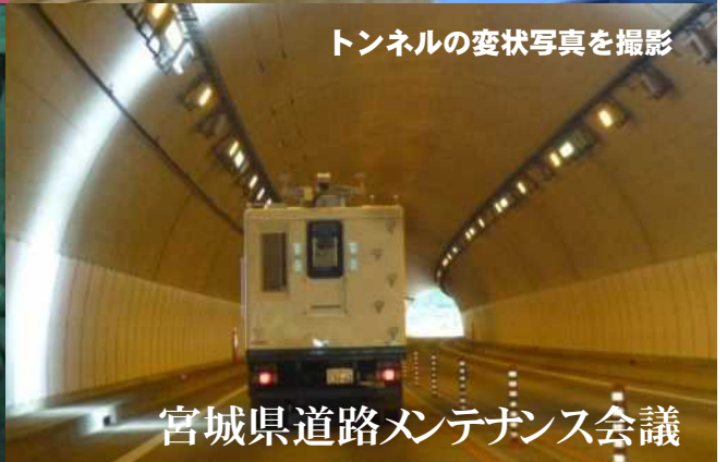
コンクリートのうき・はく離を非破壊で検査
