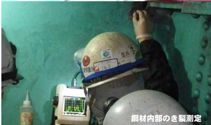
鋼材内部のき裂測定
