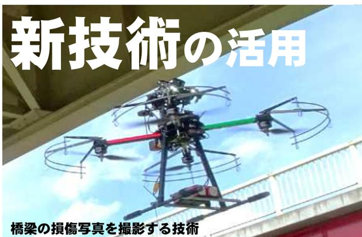
橋梁の損傷写真を撮影する技術
