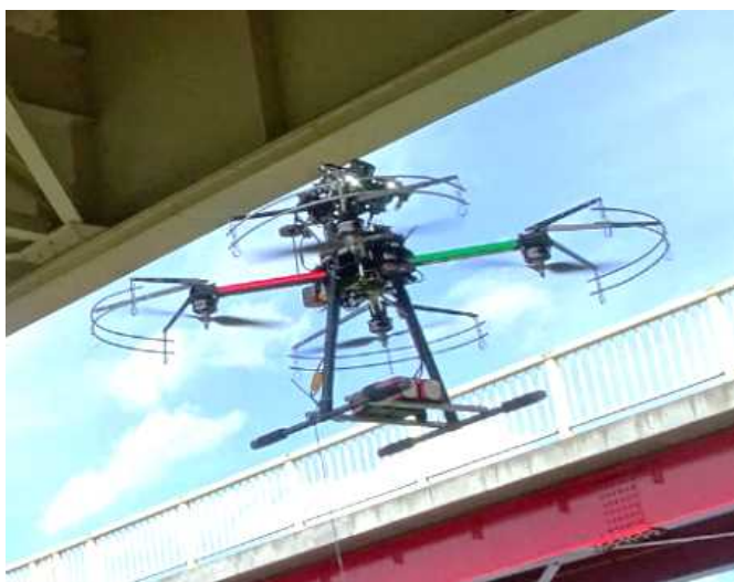
▲橋梁の損傷写真を撮影する技術
