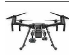
▲ドローン・AIを活用した橋梁点検・ 調書作成支援技術 (主桁外面)
