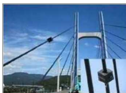
▲斜張橋斜材点検装置 コロコロチェッカー (ケーブル一般部、 定着部)
