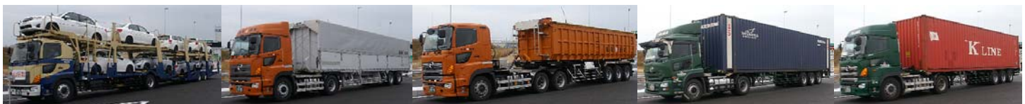
▲パレードに参加した大型車(左から、21mフルトレーラー(8台積み)、ウイングトレーラ、ダンプトレーラ)、コンテナ車(45ft、40ft)
