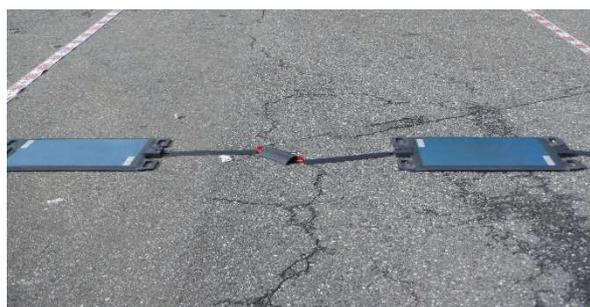
こちらのマットスケール(重量測定機)で車両の重量を計測します。
