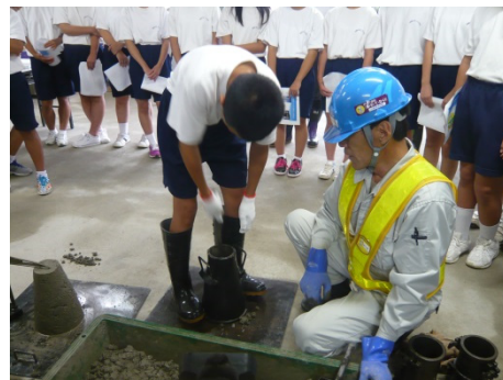
生コンクリートで試験体を作成
