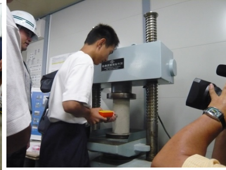
コンクリートの強度を計測
