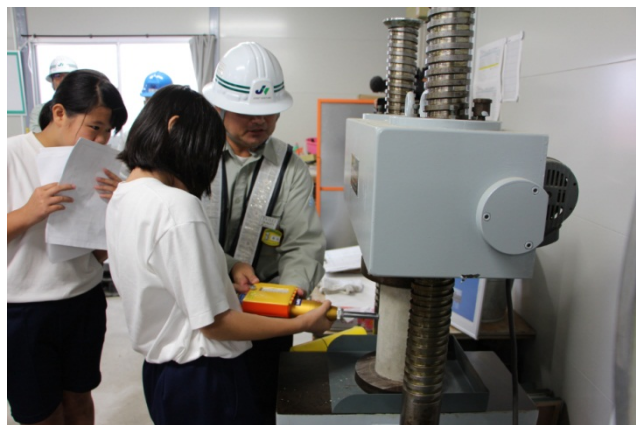
▲固まったコンクリートの強度をシュミットハンマーを使って測定
