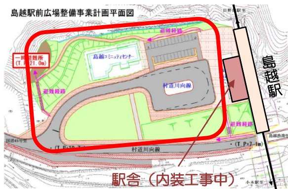
▲島越駅前広場整備事業の計画平面図 提供した土砂は地盤かさ上げ（赤枠部分）に活用されます
