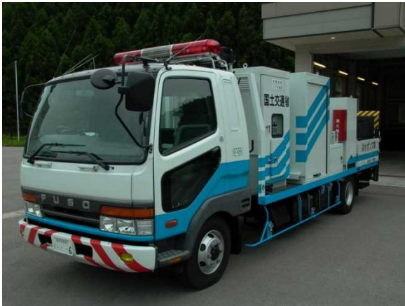
酒田河川国道事務所に配置されている排水ポンプ車
