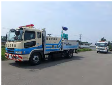
▲排水ポンプ車(手前60m 3 、奥30m 3 )
