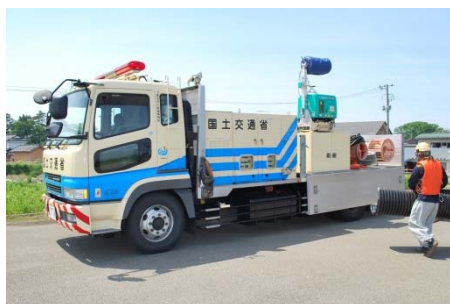
▲排水ポンプ車(毎分60m 3 )
