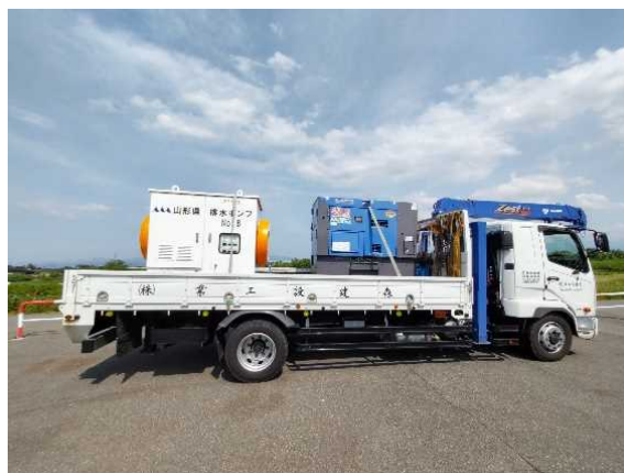
▲山形県の排水ポンプ車
