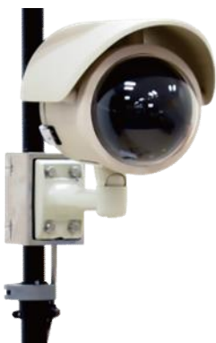
設置した簡易型河川監視カメラ
