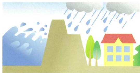
洪水を防ぐために設置した土手。
