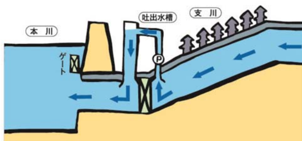
排水機場の仕組み
