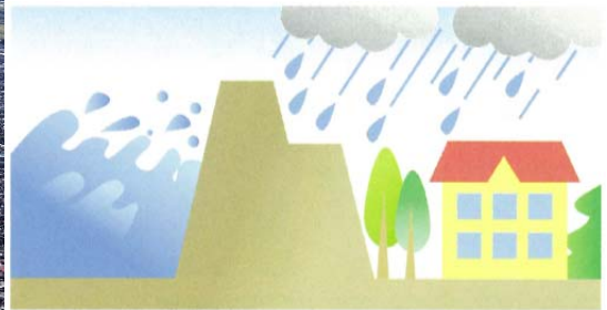
洪水を防ぐために設置した土手。
