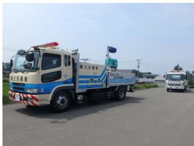
▲排水ポンプ車(手前60m 3 、奥30m 3 )
