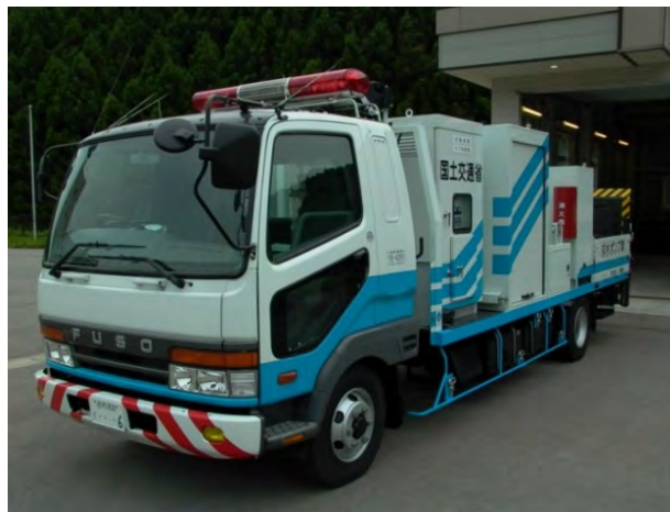
酒田河川国道事務所に配備されている排水ポンプ車
