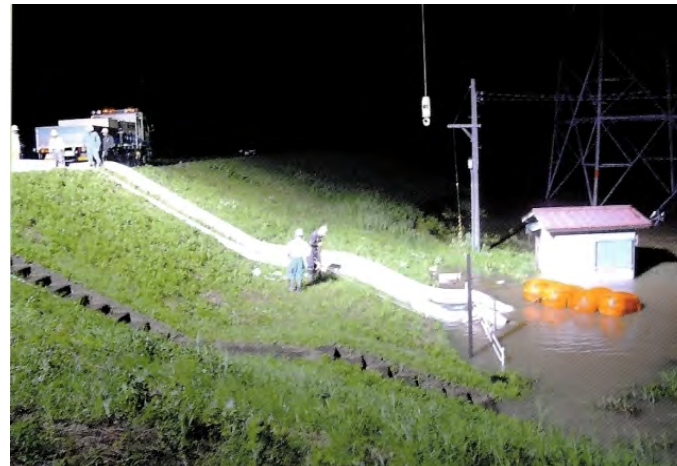
排水ポンプ車による内水排除状況
