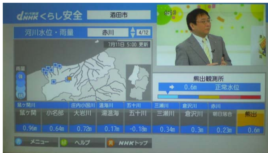
図 5-22 地上デジタル放送(データ放送)による河川情報の提供例(NHK 山形放送局の例)
