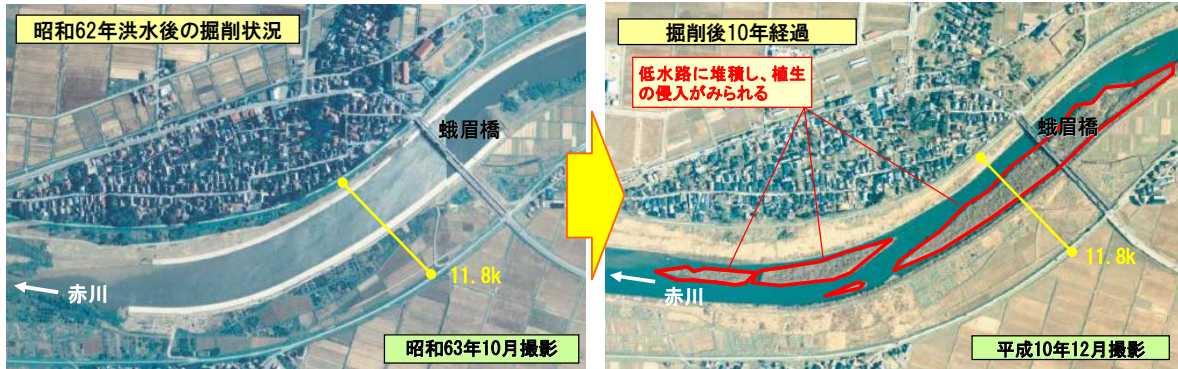
図 3-6 河道掘削後の経年変化
