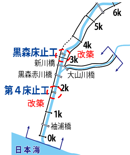
図5-3 改築が必要な床止め工
