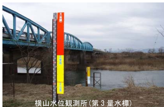
図 3-24 水位危険度をわかりやすく表示した量水標と説明看板
