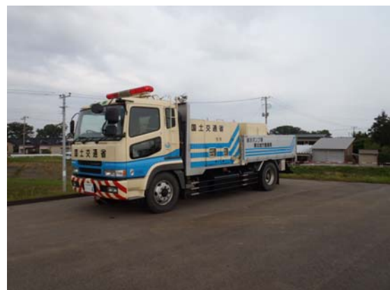
排水ポンプ車 (酒田河川国道事務所配備：60m 3 /分)
