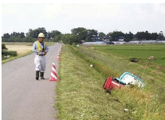
遠隔操作による堤防除草の様子
