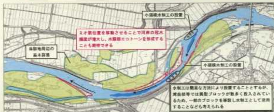
図 水制工設置イメージ (平面図)
