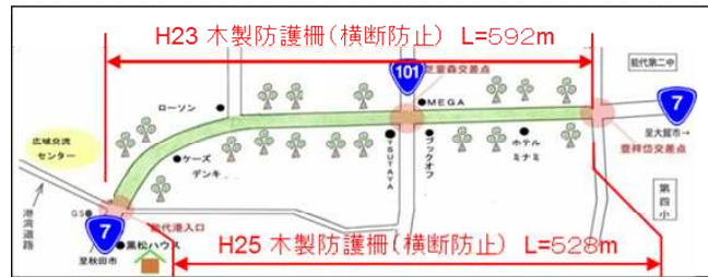
▲木製防護柵設置状況
