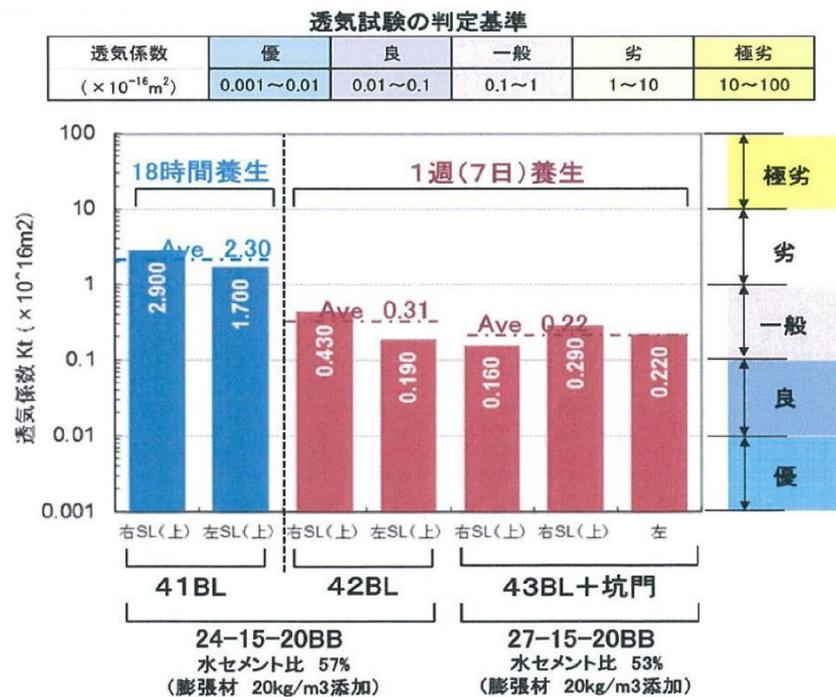
図 6-6 表層透気試験の結果
