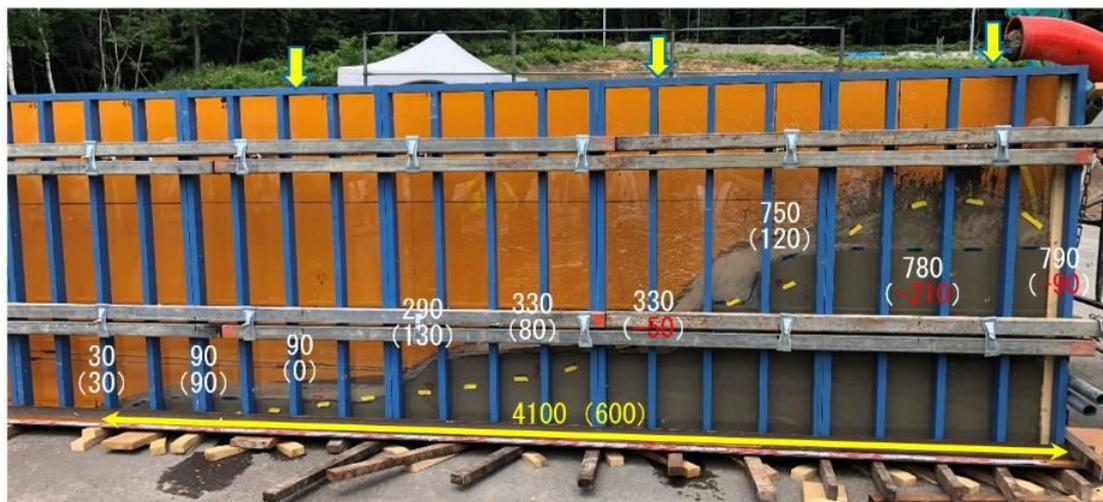
写真 6-15 10秒締固め
