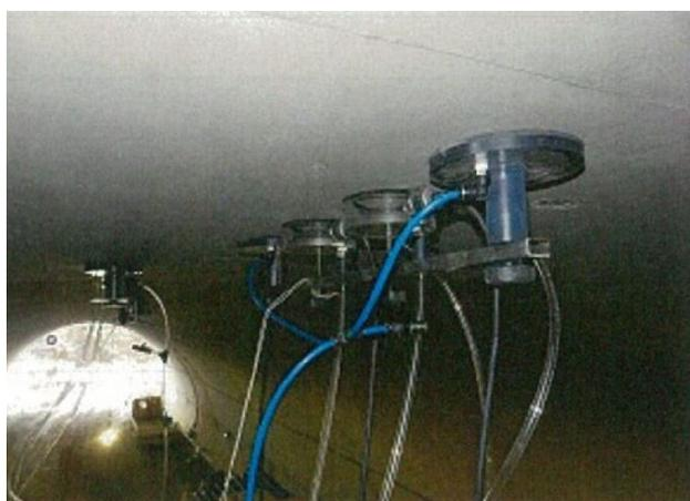
写真 6-7 天端部分の表面吸水試験
