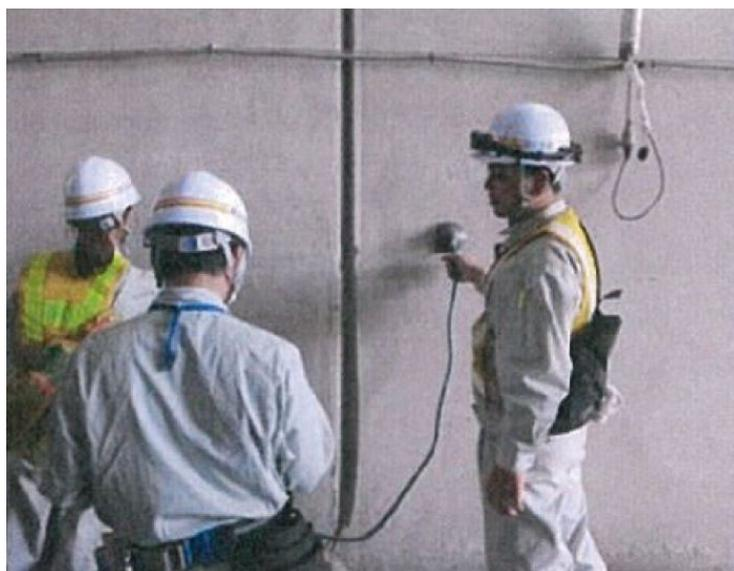
写真 6-6 表層透気試験状況
