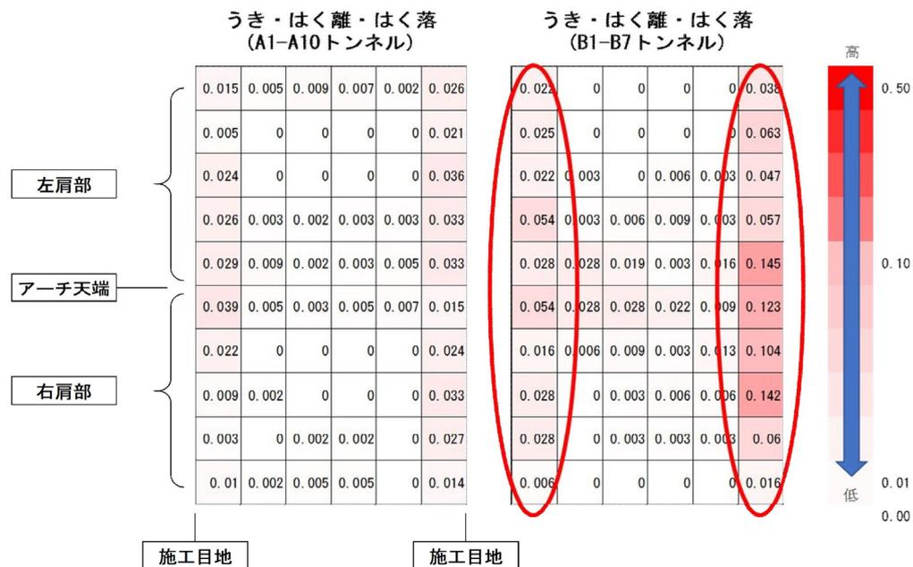
図 1-19 うき・はく離・はく落の発生状況の変化
