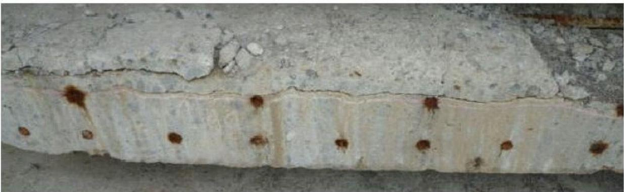
写真 1 - ⑱ 床版交換により撤去したR C床版（S 5 5年竣工）の上縁鉄筋に沿ったひび割れとその上部コンクリートの劣化状況
