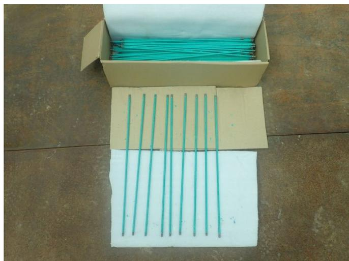
写真7-⑰ 地覆用セパレータを樹脂被覆した例
