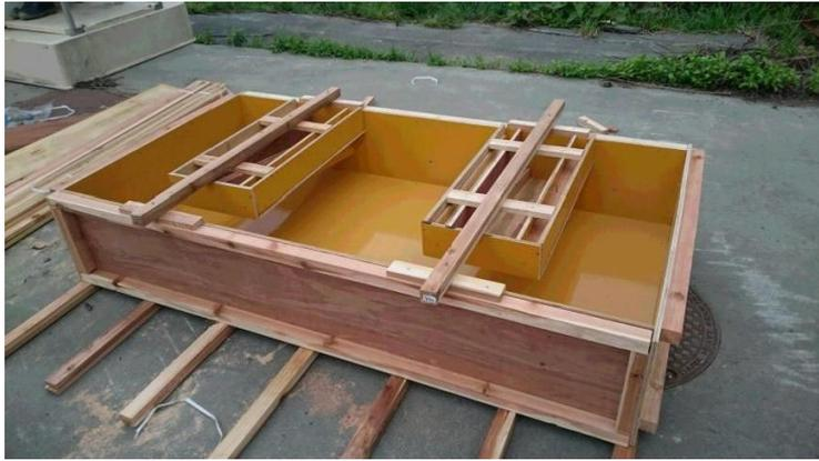
写真6-2-⑥ 模擬床版に模擬排水柵をセットしたところ
