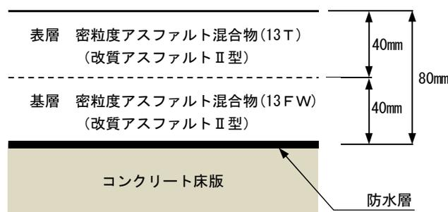
図12-① 橋面舗装の舗装構成
