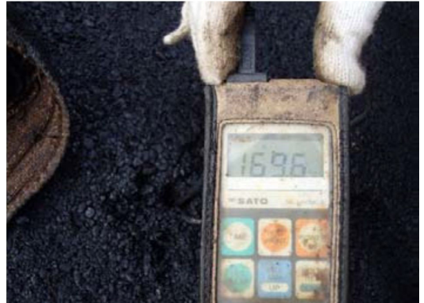
写真-1 到着時再生密粒 13T 改質Ⅱ型※170°C±10 実測値 169°C
