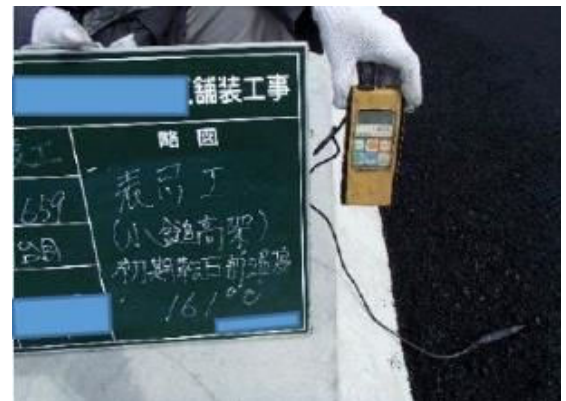
写真-2 初期転圧時再生密粒 13T 改質 II 型※155°C±10 実測値 161°C
