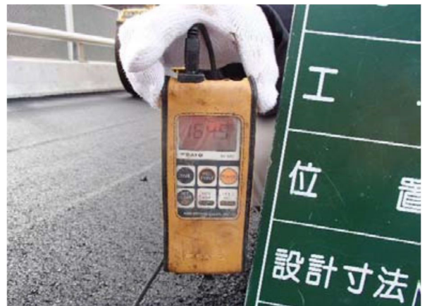
写真-2 初期転圧時再生密粒 13T 改質Ⅱ型※155°C±10 実測値 164°C
