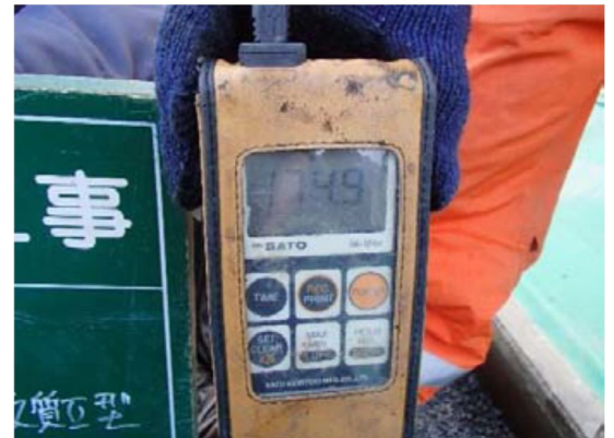
写真-1 到着時再生密粒 13T 改質 II 型※170°C±10 実測値 174°C
