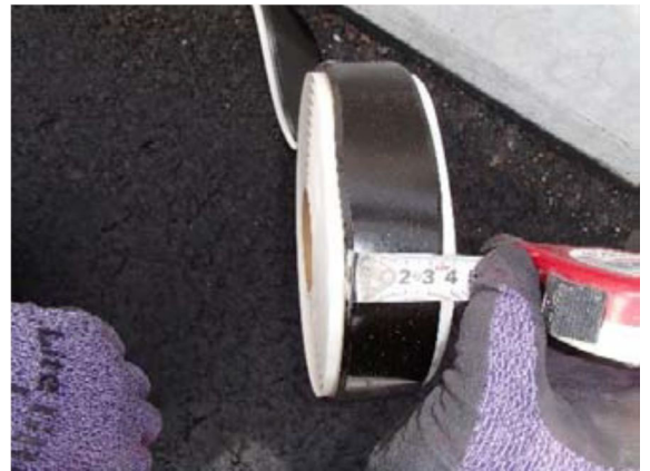
写真-2 成型目地材(近接) 幅 30mm 厚さ 5mm
