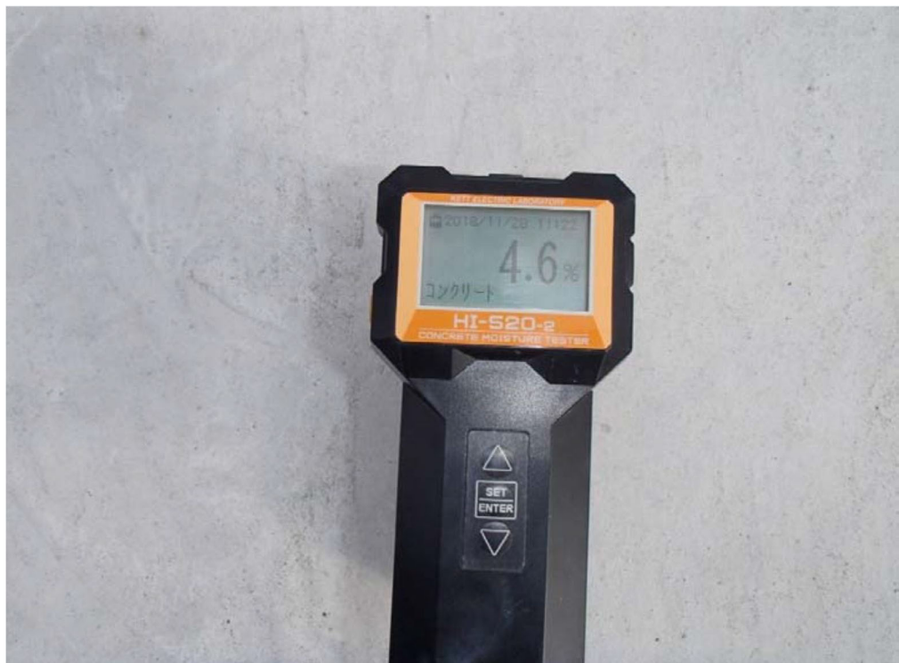
写真-2 水分量測定値 4.6% (近接:A) 高周波水分計による測定結果
