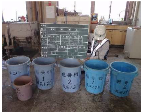
材料計量状況
