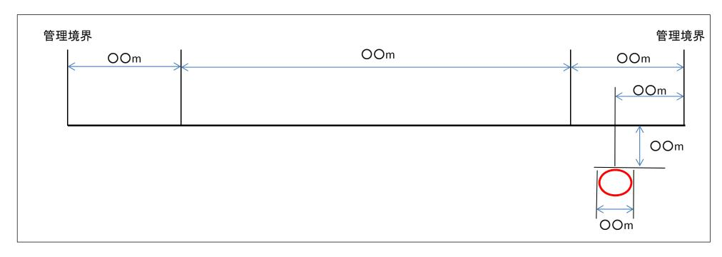
占用物件が道路地下埋設物、電柱・電話柱の場合は、必ず作成してください。 占用物件が電線の添架の場合は、平面図に路面高を記入した図でも構いません。
