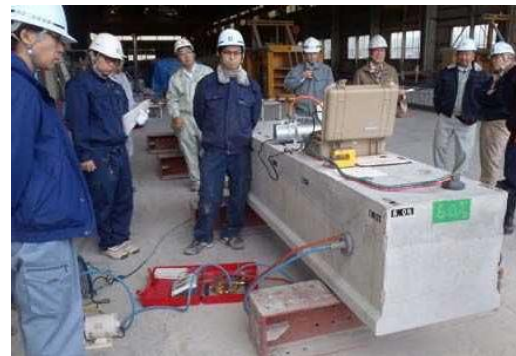
写真-2 表層透気性に関する調査状況
