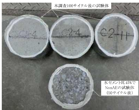
写真-3 スケーリング試験後の状況
