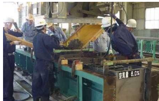
写真-1 新仕様 6.0%試験体の製作状況
