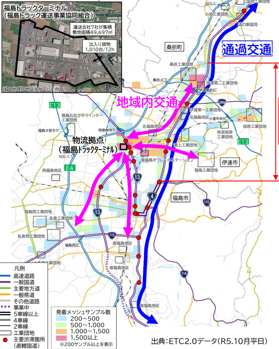
【図1】対象区間周辺の主な物流発着地と地域内交通・通過交通の動き
