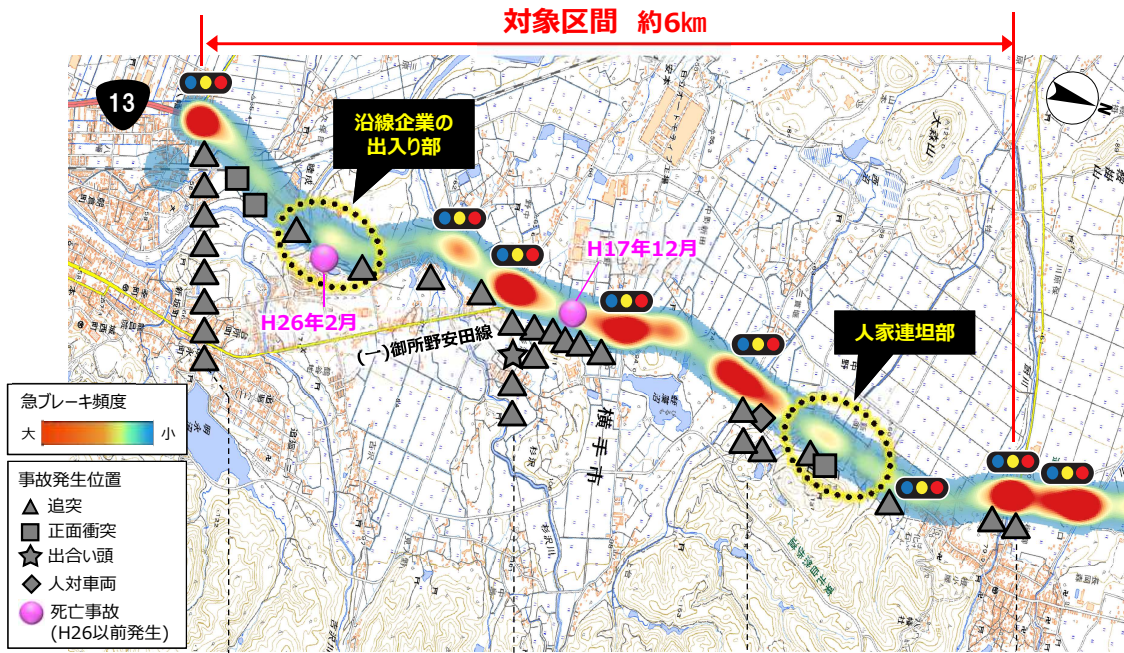
【図1】国道13号の死傷事故率と発生箇所
