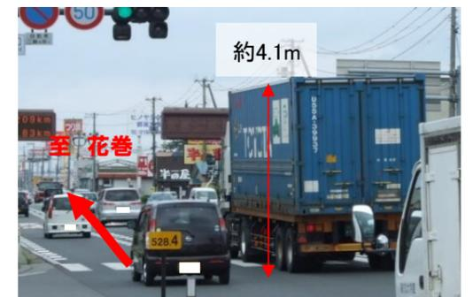
海上コンテナを積載した場合、荷台の高さは約4.1mとなり、国道4号に並行する県道・市道では、基準の3.8mを超えてしまいます
