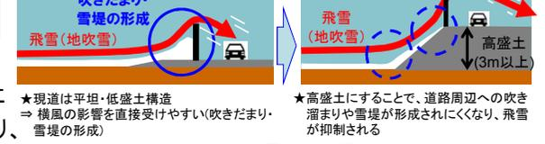
図9 飛雪抑制効果
