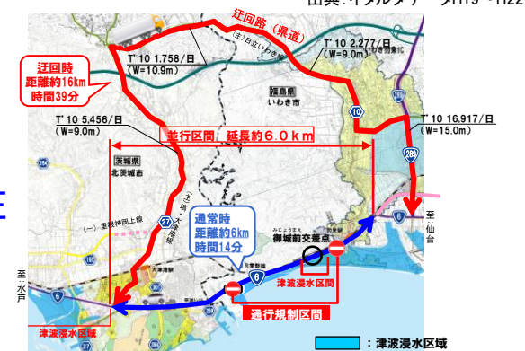
図7 国道6号の津波浸水、迂回路状況
