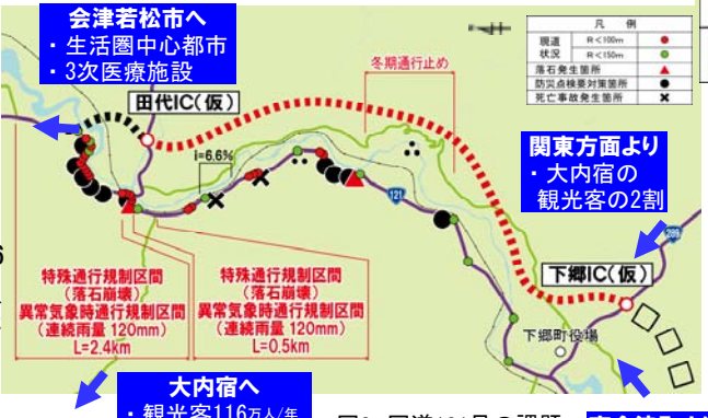
図2 国道121号の課題 南会津町より
