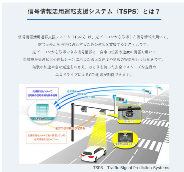
図 4-75 信号情報活用運転支援システムの概要
