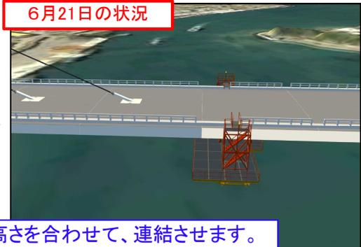
※ステップ①の後、徐々に桁の高さを合わせて、連結させます。
