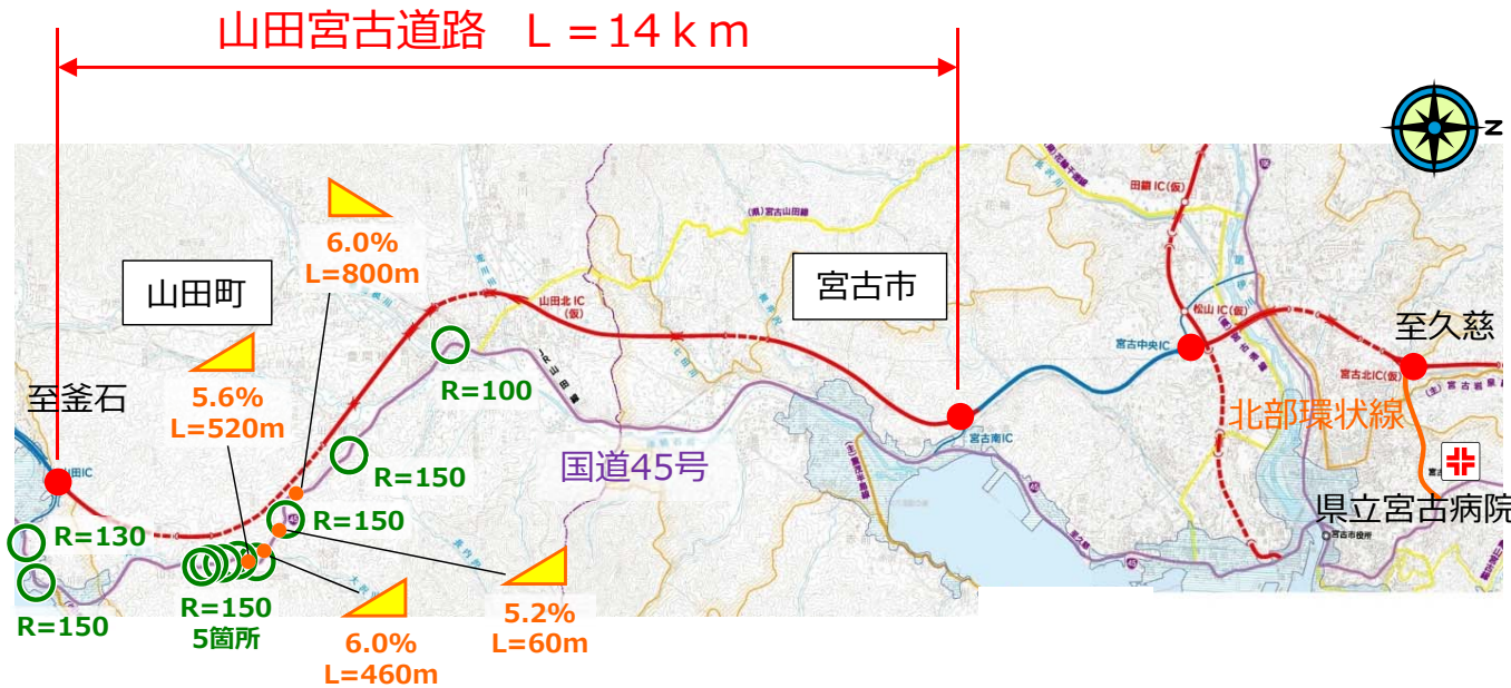
▼現道の隘路状況
