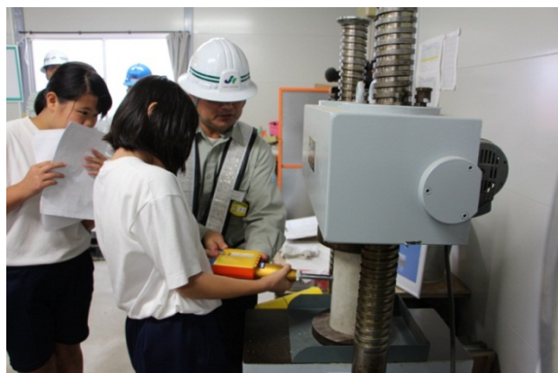
▲コンクリートの強度をシュミットハンマーを使って測定
