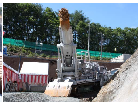
▲トンネル掘削時は、このブームヘッダーという大きな機械が活躍します
