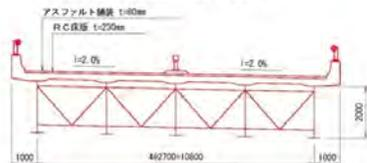
PC5径間連続バルブT桁橋(L=182.5m)
