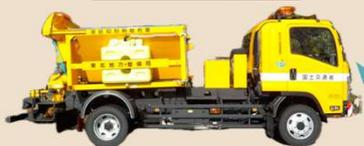
車両後方に付いている装置で凍結抑制剤を散布し、路面を凍りにくくします。
