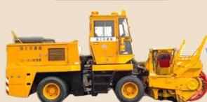
前方のオーガで雪をかき集め、投雪します。車道脇の除雪に使用します。
