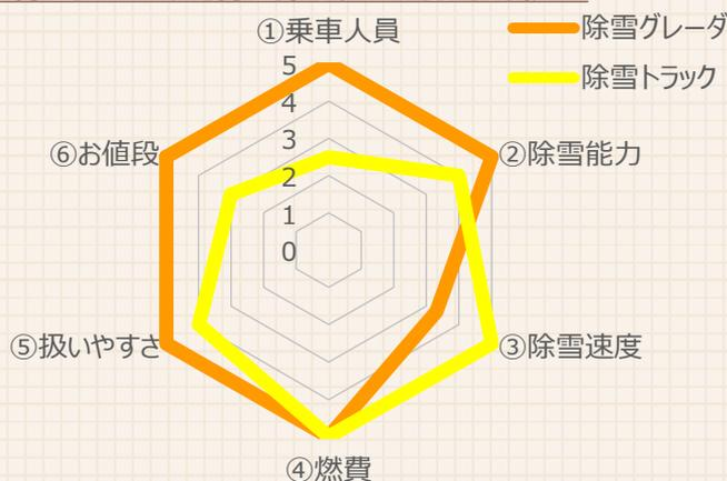
比較の結果、除雪グレーダに分がありそうですが、除雪トラックは山間部や自動車専用道路での除雪を得意としております。除雪機械は、それぞれの特徴を活かし、適材適所で配置しております。
