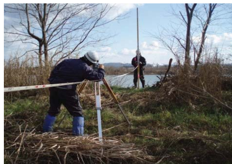
定期横断測量の状況
