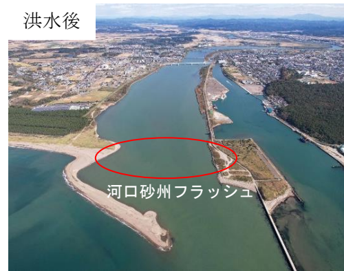
令和4年（2022年）8月洪水による河口砂州の変化
