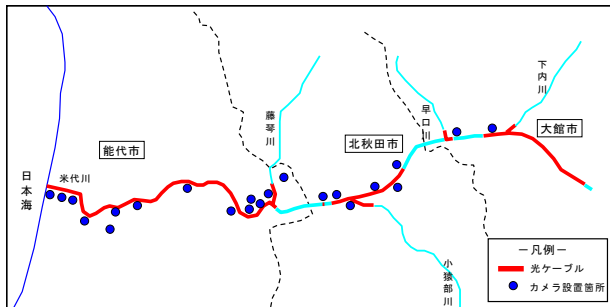
図 6-36 光ファイバー及び河川情報カメラ整備状況
