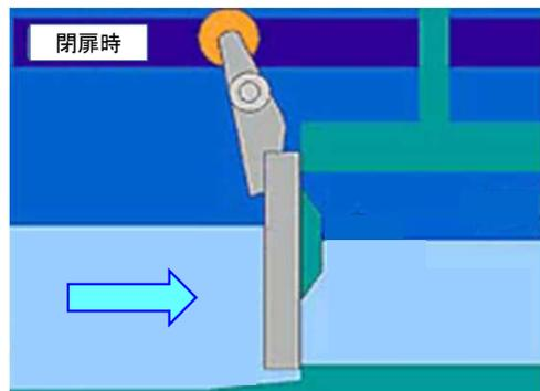
■ 緊急時または操作遅れの際は内外水位に対応したゲートの自動開閉により操作の確実性、迅速性、信頼性向上が図られる
