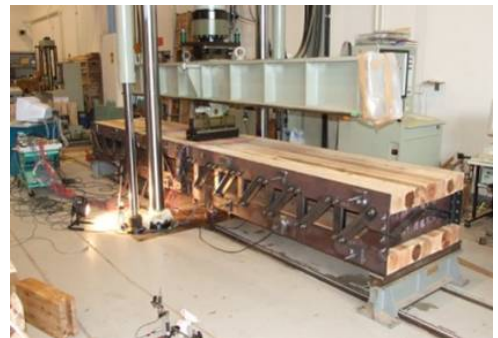
開発した木橋の強度試験（木高研）
