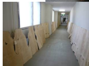
伐採された学校の木が長さ 1m に切り揃えられて木高研に運び込まれました(上)。かつら剥きにされた木は試験棟の廊下で自然乾燥させます。前を歩くと樹種による香りの違いがわかります。(下)。
