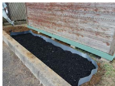
長さ3m, 奥行き90cm, 深さ20cmの試験地には17袋の黒松炭を撒きました。雑草の侵入と炭の飛散防止のため, 10cmほど高くして周囲を畦シートで囲みました。
